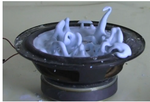
(b) Verdickungseffekt auf einem Lautsprecher (siehe Bend [7]).
